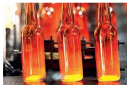
Kapazität erhöht: Eine Triple-Gob-Glasblasmachine der Firma Vetropack, wie sie in St-Prex in Betrieb genommen wurde.
