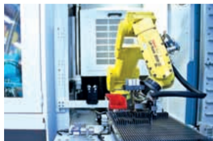
Roboter für die automatische Bestückung einer 5-Achs-gesteuerten CNC-Profil-schleifmaschine bei Oertli Werkzeuge AG.
