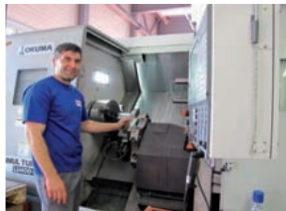
Mit dem neuen Drehzentrum von Stutz lassen sich Teile bis 450 mm Durchmesser bearbeiten
