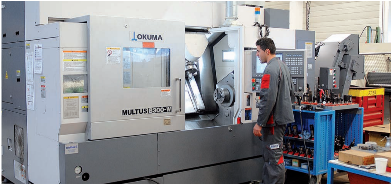
Hochtechnologie bei Stutz Mechanik: Dreh-/Fräszentren für die Bearbeitung komplexer Werkstücke (Foto: P+S Werbung)
